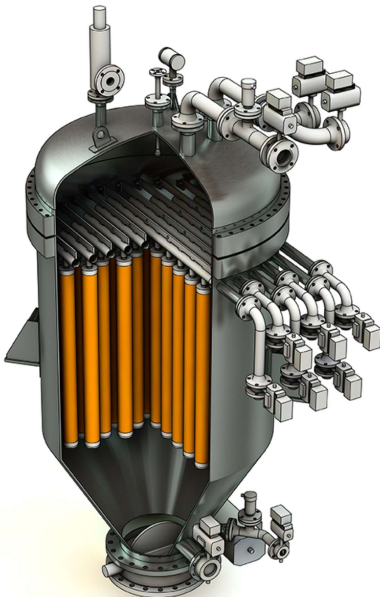
完整的CF型蜡烛过滤器设备，过滤面积为20m 2
